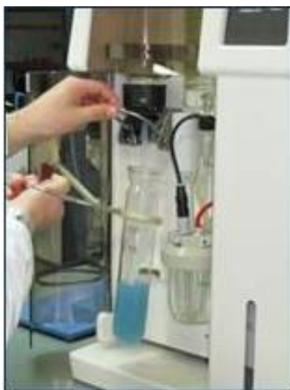
Slika 6: Določanje vsebnosti beljakovin – destilacija vzorcev (foto: A. Čanžek Majhenič)
