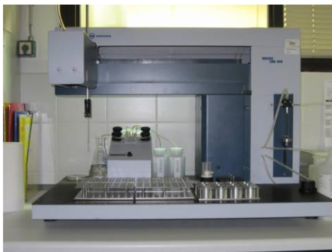
Slika 8: Določanje vsebnosti laktoze – Microlab ® EFA (foto: A. Čanžek Majhenič)
