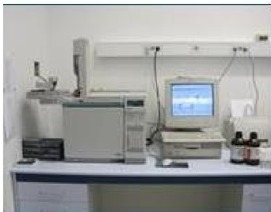
Slika 7: Določanje vsebnosti maščobnih kislin – plinski kromatograf (foto: A. Čanžek Majhenič)
