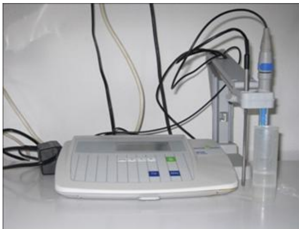
Slika 10: Določanje vrednosti pH – pH meter (foto: A. Čanžek Majhenič)
