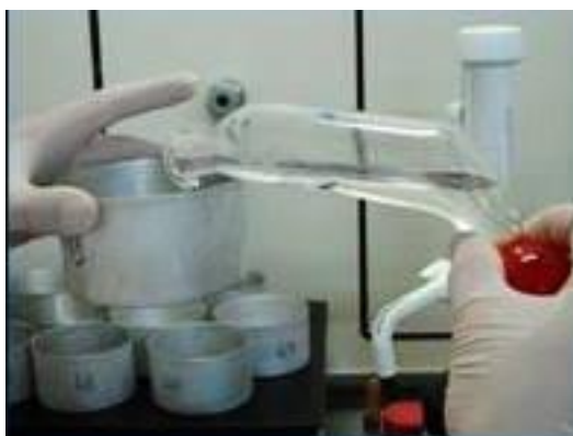
Slika 5: Določanje vsebnosti mlečne maščobe - odlivanje organskega topila z ekstrahirano maščobo (foto: A. Čanžek Majhenič)
